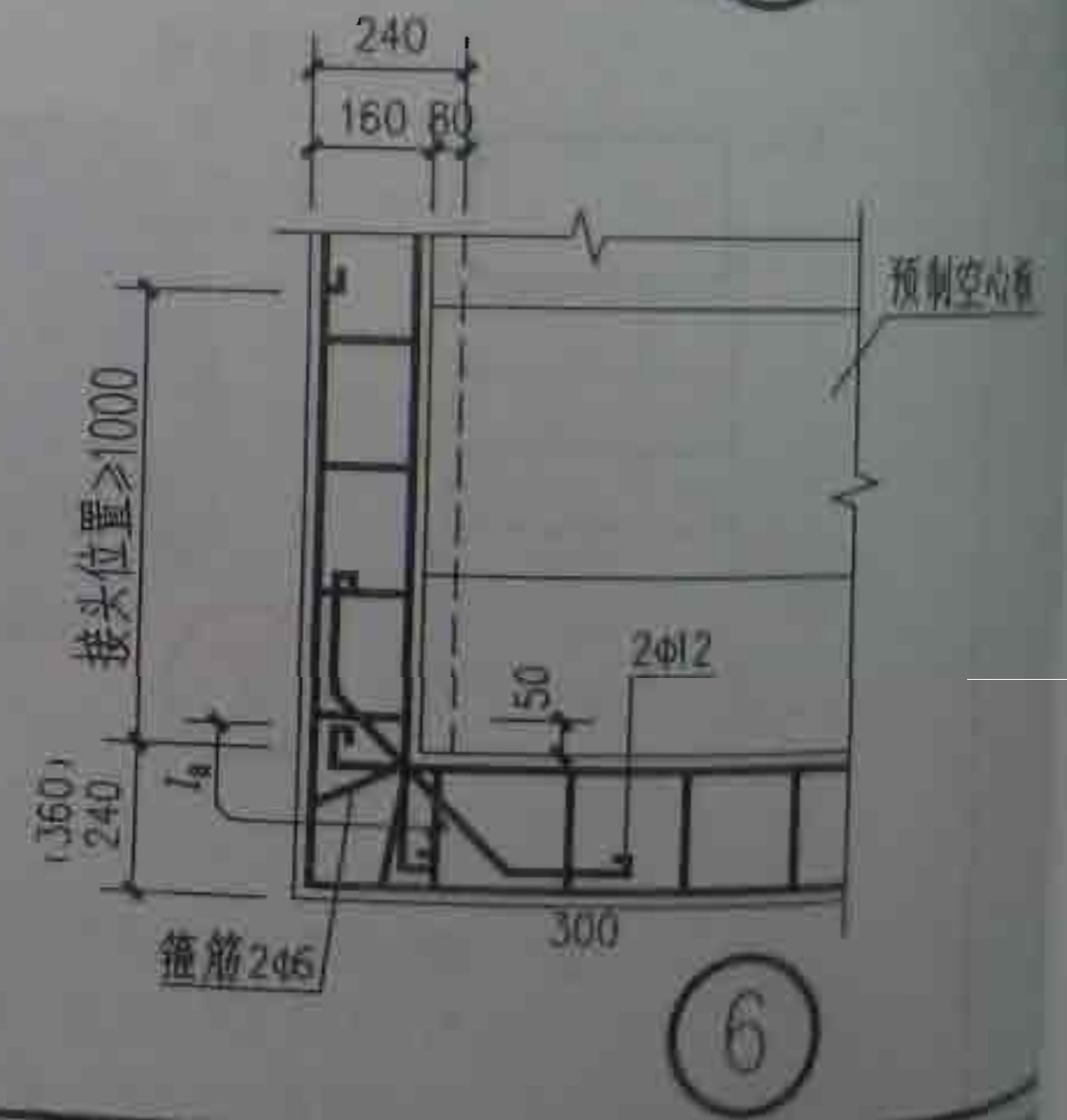
板平圈梁平面型节点 (无构造柱)
